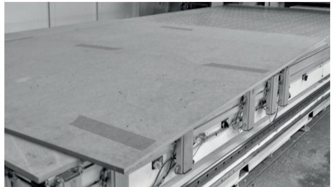
2. Paso seguido se da la vuelta al tablero de MDF para maquinarlo por la cara opuesta. Se procede a cortar las ranuras que van de este lado (en el plano; Superficie desplegada, cara superior, MDF 15mm) y luego, el perímetro, con una profundidad pasante de 15 mm). Así termina el proceso de corte y ranurado de la superficie que servirá de asiento, espaldar y de apoyo brazos.
