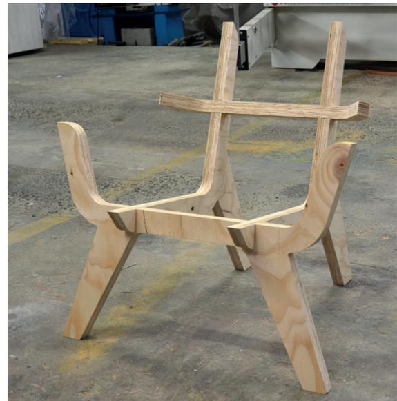
6. Entre las ranuras del doblado de la pieza se vierte pegamento tipo PVA, previniendo los excesos. Después se humedece la membrana por la cara exterior y se flexiona gradualmente para estirar, poco a poco, las fibras del material.
